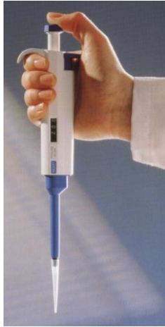
Pipettor đơn (một kênh), cơ
